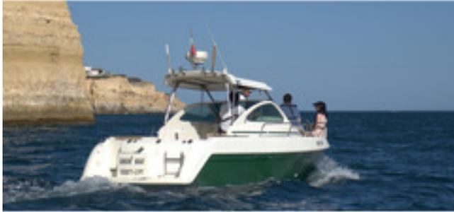
Embarcação GreenBoat: Embarcação denominada: "GREEN BOAT" com o conjunto de identificação número 103071-3PT, com o comprimento 8.05m, boca 2.87m e pontal 1,33m, com arqueação 7.270, equipada com um motor interior marca Volvo Penta 200 HP.
